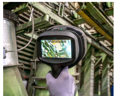
Die FLIR Si2-LD erkennt zwei Quellen möglicher Druckluftlecks, die sich von Hintergrundgeräuschen unterscheiden.
